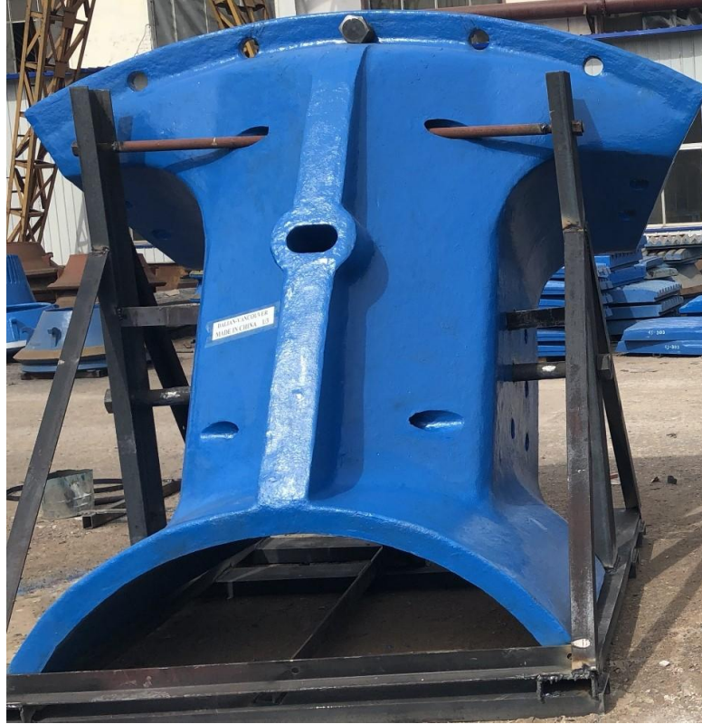
60-89 revestimiento spider modificado para mina Copper Mountain (CAN). Se añadió barra rompe-rocas.
